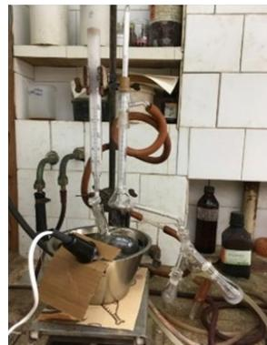
Рисунок 4. Фракционная перегонка циклобутилметилциннамата
